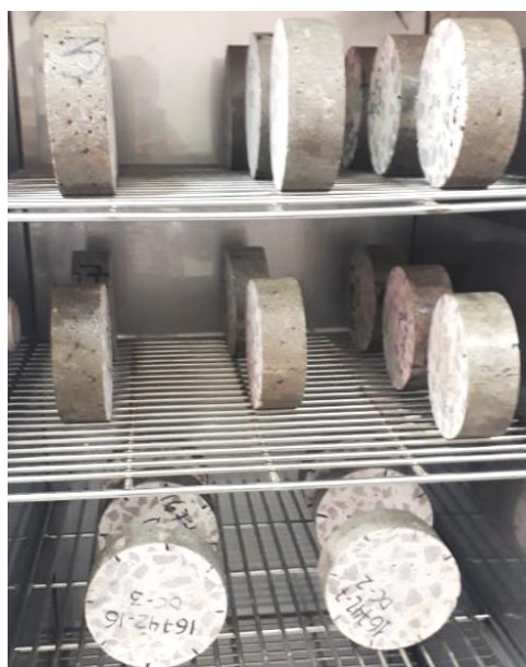
Figura 2. Amostras de concreto em câmara climática
