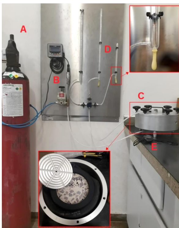
Figura 3. Permeômetro Cembureau, em que: (a) Suprimento de ar; (b) Regulador de pressão com manômetro; (c) Célula de ensaio com corpo de prova; (d) Medidores de fluxo; (e) Cronômetro.
