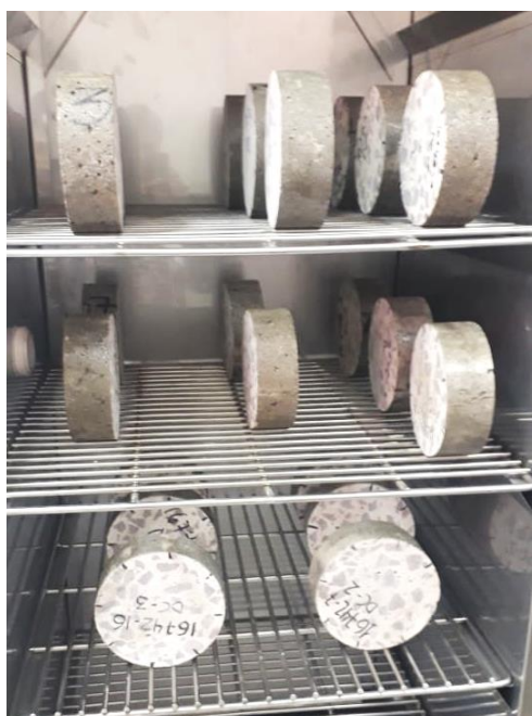
Figura 3. Amostras de concreto em câmara climática
