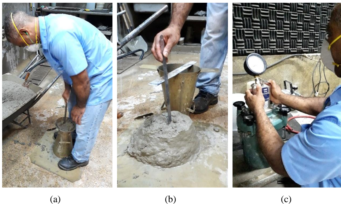
Figura 1. Avaliação das propriedades no concreto fresco. (a) (b) Abatimento de tronco de cone; (c) Determinação do teor de ar incorporado
