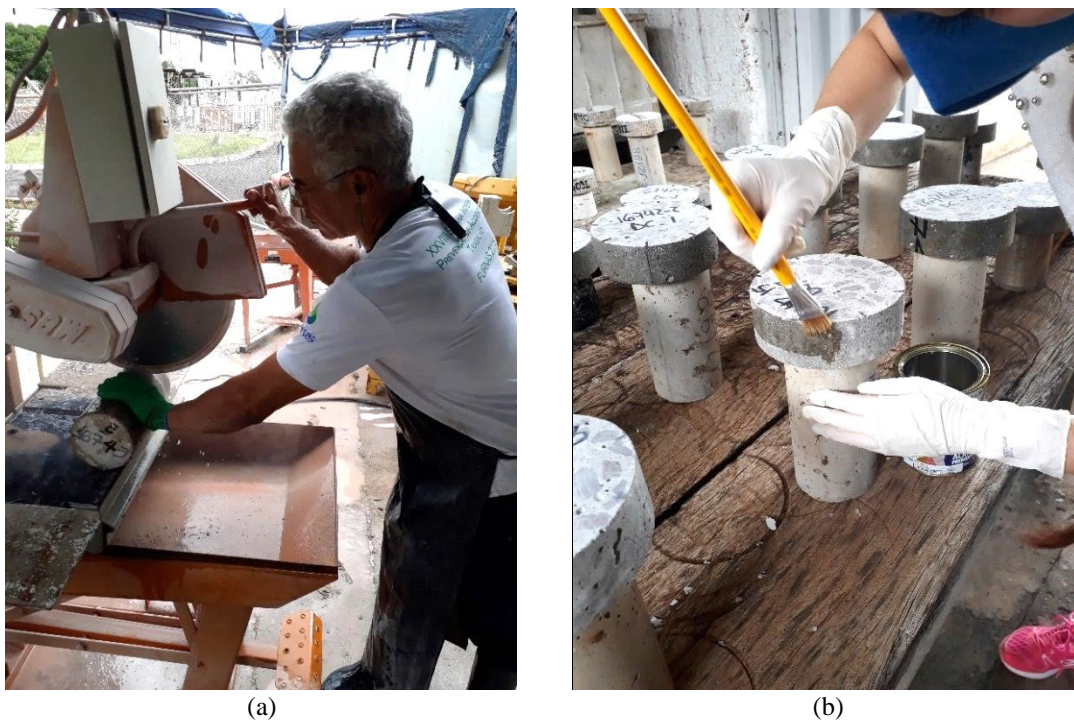
Figura 2D. Processo de (a) extração e (b) impermeabilização lateral dos discos de concreto
