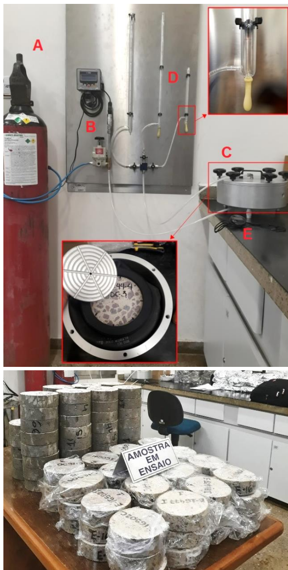
Figura 7. Permeômetro Cembureau e amostras armazenadas após ensaio de permeabilidade ao gás. (a) Suprimento de ar; (b) Regulador de pressão com manômetro; (c) Célula de ensaio com corpo de prova; (d) Medidores de fluxo; (e) Cronômetro.
